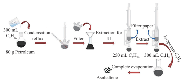
图1 石油沥青质的提取流程示意图
